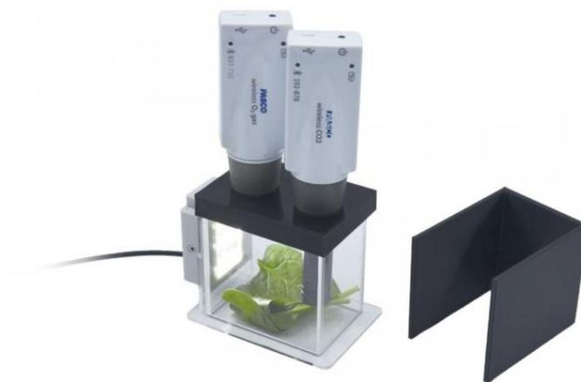
Cette enceinte simplifiée permet l'utilisation simultanée des capteurs à dioxygène et dioxyde de carbone gazeux.
