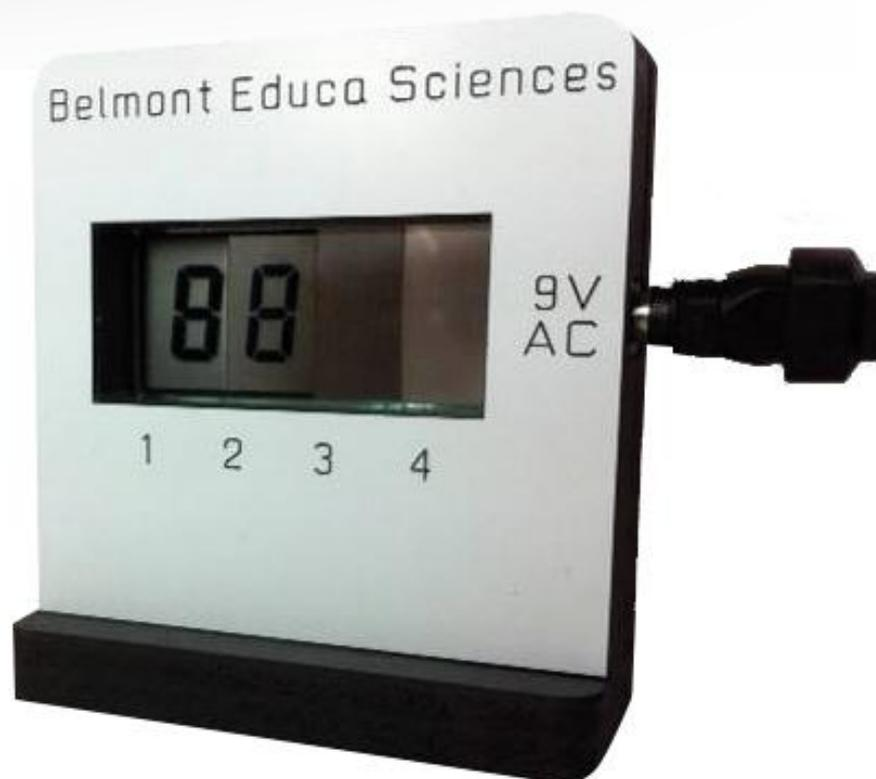
Module d'étude du fonctionnement d'un écran LCD et des phénomènes de polarisation.
