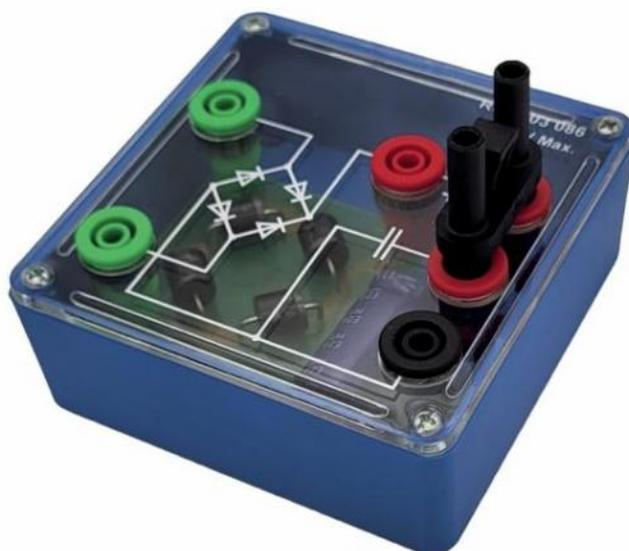
Le pont de diodes est constitué d'un module en boîtier avec douilles de sécurité permettant d'étudier le redressement et le filtrage du courant alternatif.
