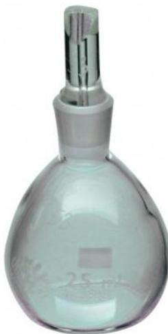
Flacon à densité en verre borosilicaté permettant de déterminer la densité des liquides.
