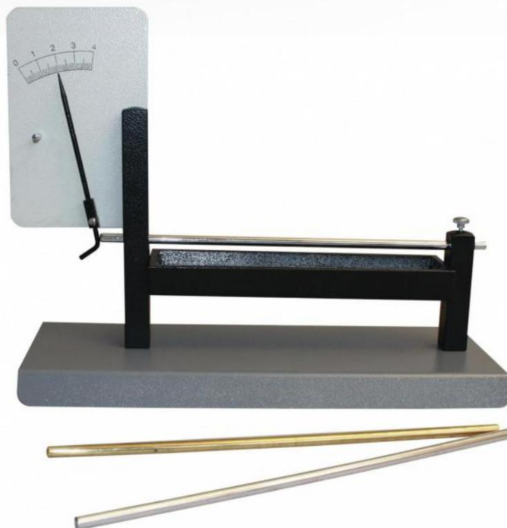
Appareil servant à démontrer que la dilatation des métaux dépend de leur nature. Livré avec 3 tiges de 200 mm de natures différentes.
