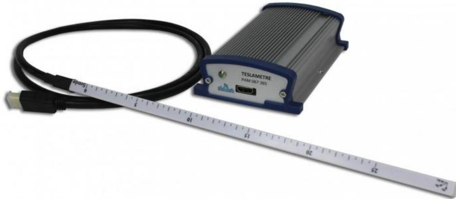
Ce Teslamètre permet la détection et la mesure de champs magnétiques de 0,1 mT à 200 mT (ou des valeurs négatives) (champ couramment créé par des courants de 2 à 10 A). Il est composé d'un boîtier et d'une sonde triaxiale graduée permettant la mesure selon 3 axes Bx, By et Bz grâce à 3 capteurs à effet de Hall.
