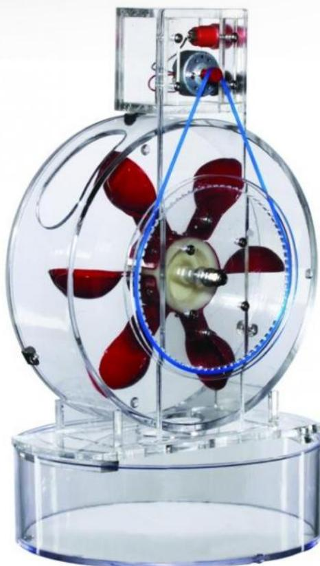
Cette turbine de Pelton montre comment l'eau courante peut être utilisée pour produire de l'électricité afin d'éclairer une ampoule ou une LED.
