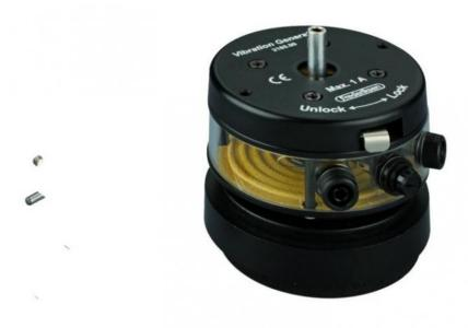
Ce vibreur électromagnétique génère de puissantes vibrations mécaniques lorsqu'il est utilisé avec un générateur de signal amplifié. Les branchements s'effectuent sur des douilles bananes Ø 4 mm sécurisées. Très robuste, il est pourvu d'un fusible et est livré avec un support de corde. De nombreux accessoires sont proposés permettant d'effectuer de multiples expériences.
