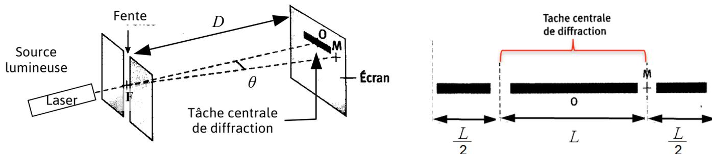
Une fente diffracte la lumière qui la traverse. Si la fente est suffisamment petite, la figure de diffraction, observée dans un plan parallèle à la fente, est constituée d'une série de tâches réparties sur un axe perpendiculaire à la direction de la fente. La relation entre l'écart angulaire  $\theta$ , la largeur  $a$  de la fente et la longueur d'onde  $\lambda$  de la source lumineuse est :
