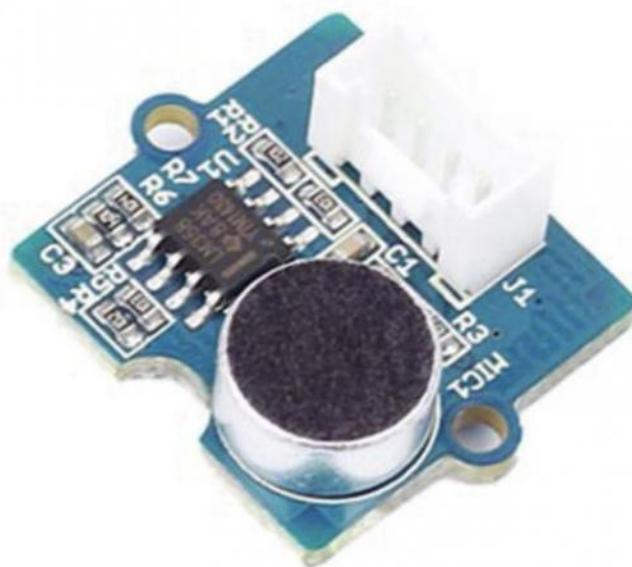
Sensibilité ajustable avec un potentiomètre. Alimentation : 4-12 V
