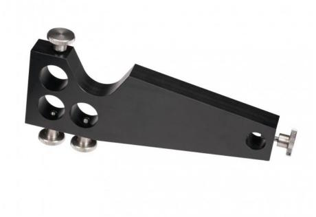
Support pour le maintien de 3 électrodes. Trois orifices Ø 16 mm pour électrodes. Un orifice Ø 11,3 mm est prévu pour la fixation sur une potence. Les électrodes sont maintenues par des vis en inox. Dimensions :  $140 \times 50 \text{ mm}$
