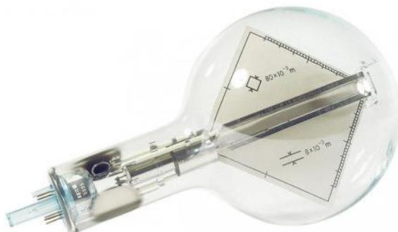
Tube permettant l'étude des trajectoires électroniques dans des champs électriques et magnétiques. Un écran fluorescent avec échelle, incliné de  $10^\circ$  par rapport à l'axe du faisceau, permet de voir l'allure du faisceau.
