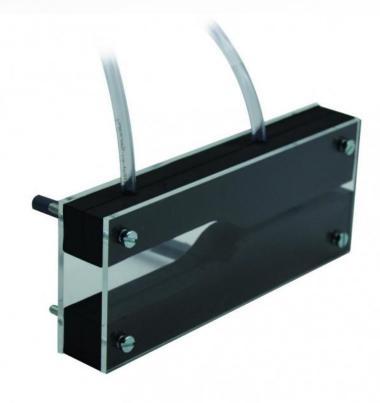
Ce dispositif permet d'illustrer le principe de fonctionnement du tube de Venturi. Il est constitué de 2 plaques de plastique transparent entre lesquelles est placé un étranglement réduisant la section en hauteur de 25 mm à 5 mm. 2 tuyaux en PVC permettent de relever la pression à l'intérieur du tube avant l'étranglement et après l'étranglement.
