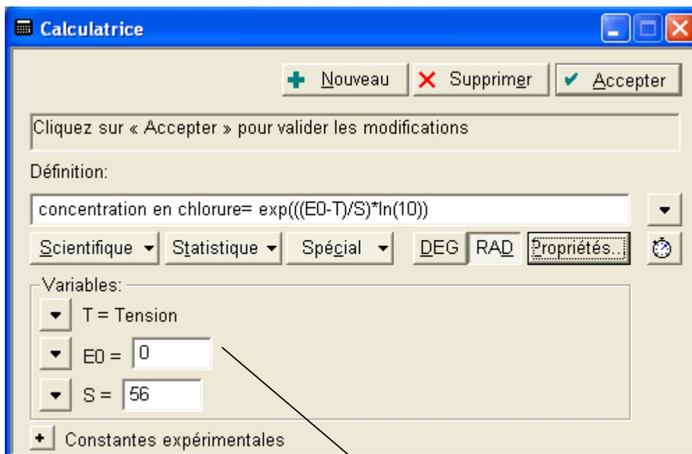
4. Pour déterminer  $E_0$ , il suffit de mesurer la tension de la solution standard 0.1M de calcium et de renseigner cette valeur.
