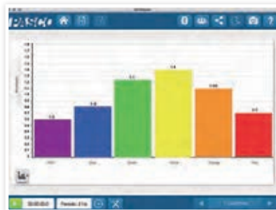
Mesure simultanément l'absorbance et la transmittance de 6 longueurs d'ondes.
