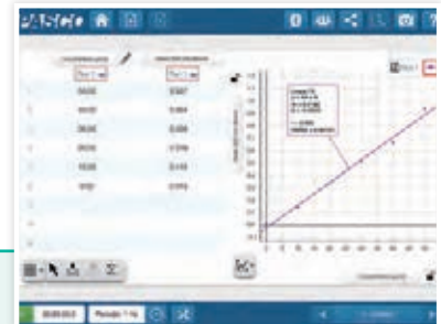
Mesure cinétique d'absorbance en fonction du temps.
